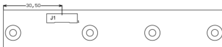
Рисунок 7 - Расположение разъёма OSD-клавиатуры
