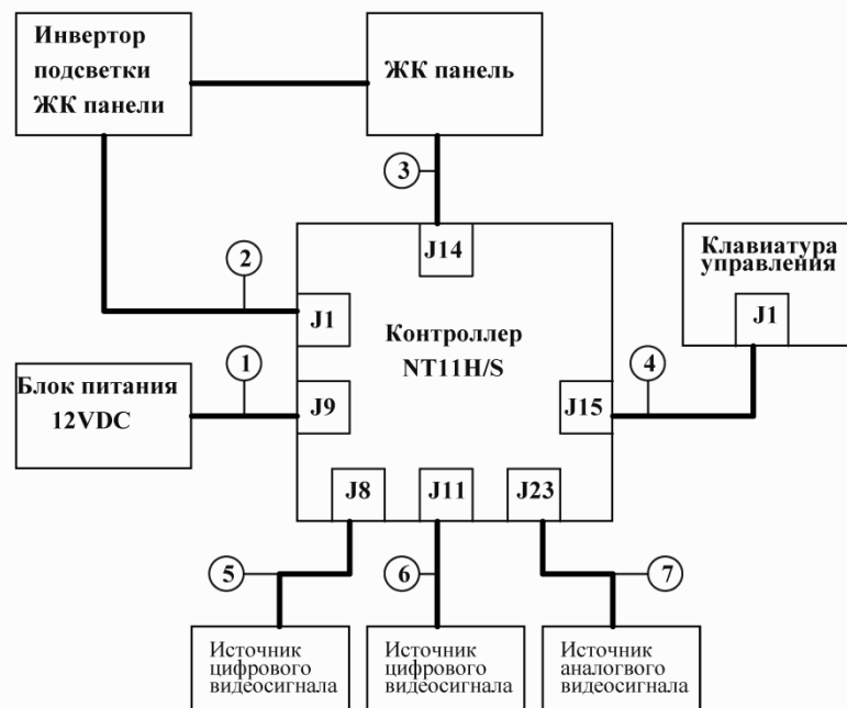
Рисунок 1 - Структурная схема устройства отображения.
